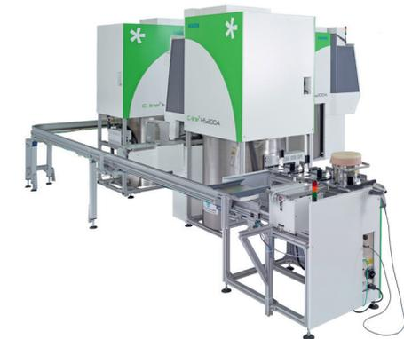
Drei C-line von Askion bieten Platz für die Lagerung von  $> 100\,000$  Proben bei  $< -130\text{ }^{\circ}\text{C}$  in mit Flüssigstickstoff gekühlten Tanks. Das Ein- und Auslagern von Proben wird ohne Unterbrechung der Kühlkette mittels eines automatisierten Transportsystems gewährleistet.
