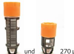
Füllmengen: 525  $\mu\text{l}$  und 270  $\mu\text{l}$
